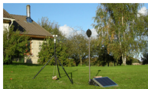
Installation des sonomètres près des habitations
