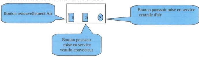
> 1 commande du renouvellement de l'air de la salle, en période froide le laisser sur 0 % pour conserver le chauffage. En été le positionner sur 100 % afin de rafraîchir la salle.
